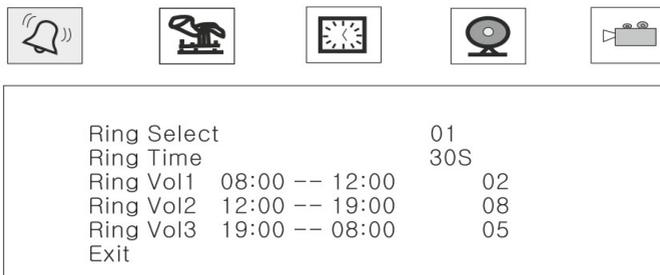
Для навигации по разделам меню используется прокрутка кнопки-колесика, а для входа в нужный раздел следует нажать на неё. Находясь в выбранном разделе, выбор нужного параметра осуществляется нажатием на кнопку-колесико, а регулировка значений - прокруткой.
